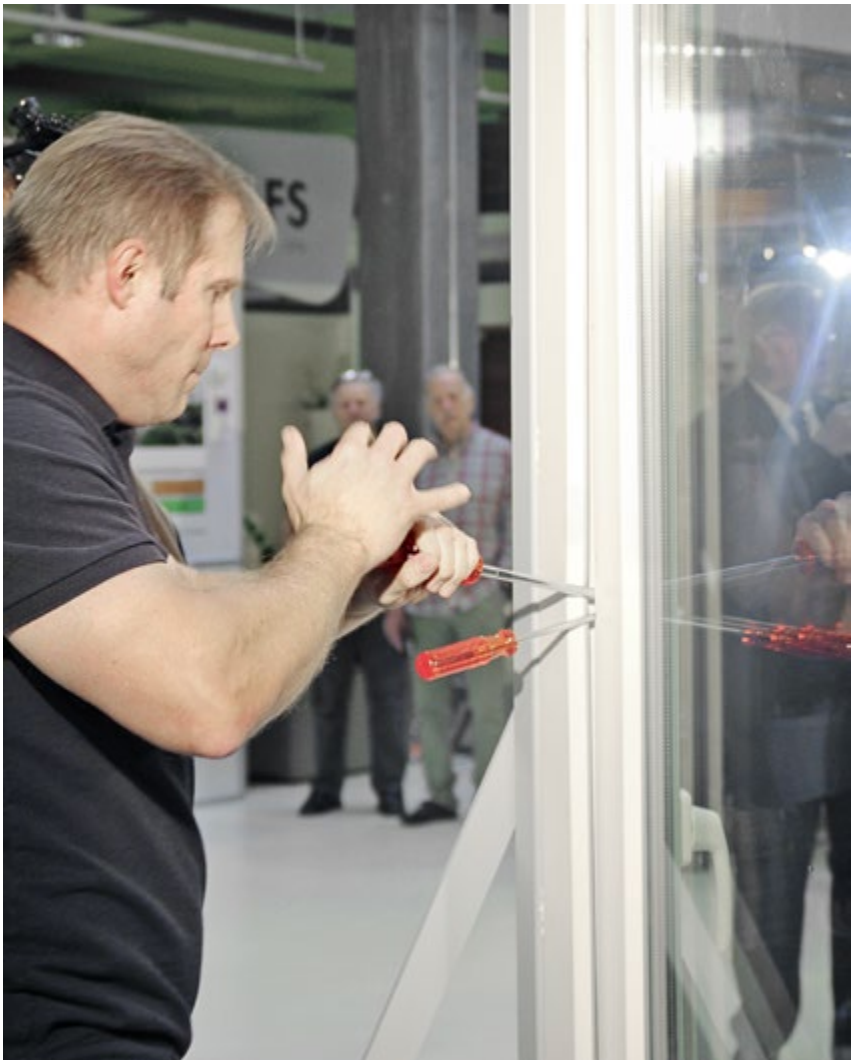
Bereits mit einfachen Mitteln und dem Einsatz vor Marginalkraft lässt sich eine Türe rasch aufbrechen.
