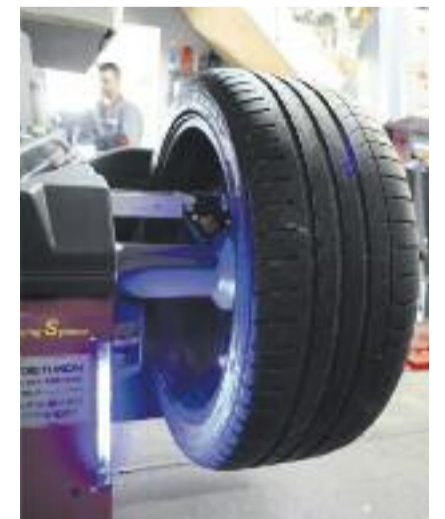
Wirket beinahe gespenstisch: Die Auswuchtmaschine mit Laser und Blue-Light-Technologie.
