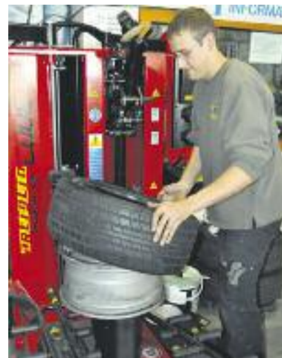
Stefan Schauffelberger wechselt an der zweiten neuen Maschine einen Niederquerschnittsreifen.
